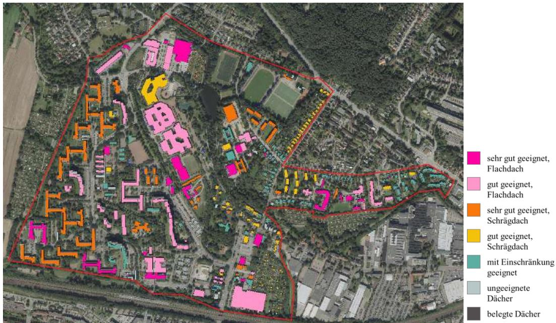
Abbildung 3-5: Abschätzung der Dacheignung für solarthermische Anwendungen
